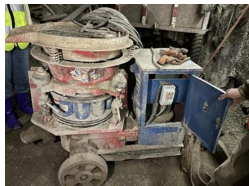
喷浆机开关箱内未设置漏电保护器
