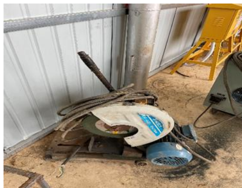
砂轮切割机手柄绝缘皮破损、绝缘不良
