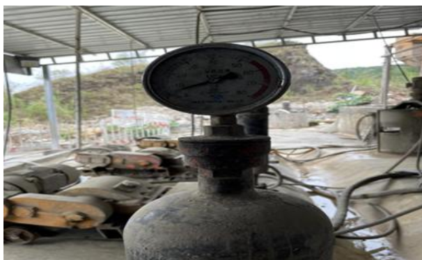
问题照片 制浆机压力表失灵
