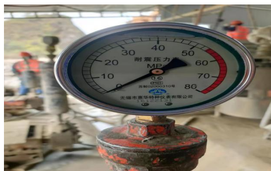
整改照片 更换制浆机压力表
