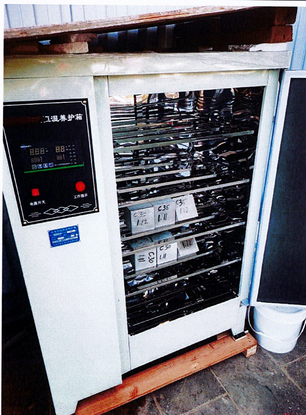
未设置砼养护室整改后
